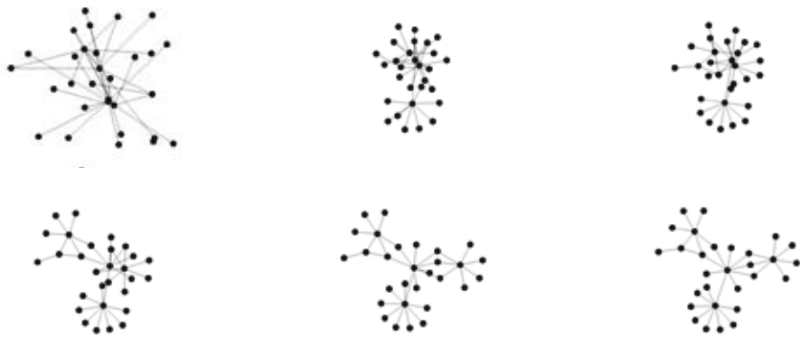
Abbildung 23: Diese Bildfolge zeigt die zunehmend idealere Anordnung mit Hilfe eines selbst entwickelten Algorithmus. Er basiert auf einer physikalischen Kräftesimulation, bei der sich alle Knoten abstoßen, also auseinanderdriften würden, aber über die Kanten laufende Anziehungskräfte den Graphen zusammenhalten. Bei allen kraftbasierten Algorithmen durchläuft das System mehrere Phasen, bis es sich einem stabilen Zustand annähert.
