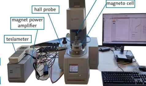
rheometer MCR102e, Anton Paar Germany GmbH
