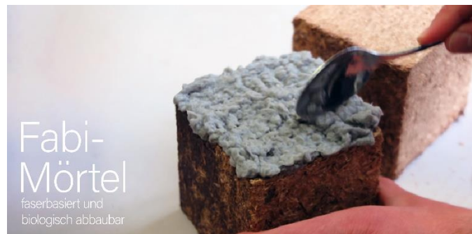
Abb. Prüfkörper in der Herstellung (©Frédéric-Philipp Habermann)
