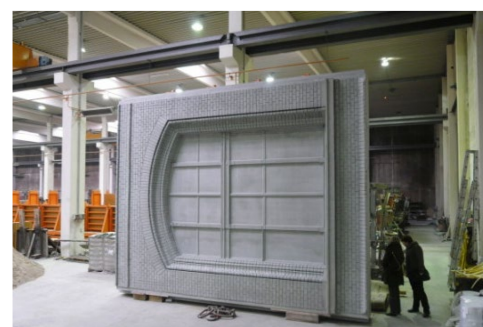
Abb. 04: Gegossenes Relief aus Beton
